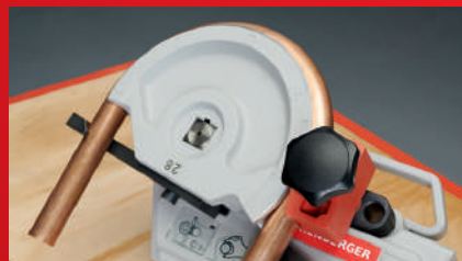
Кованые сегменты из алюминия со шкалой
