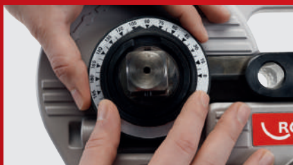
Предварительная настройка угла сгибания без использования инструмента
