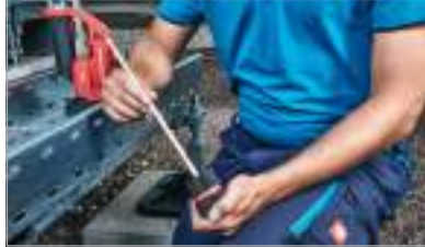
2. Снимите грат и удалите все внешние острые края
