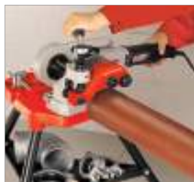
Применение устройства для накатки желобков ROGROOVER
