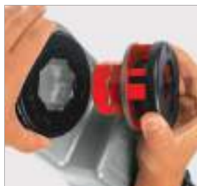
Лёгкая установка резьбонарезных головок
