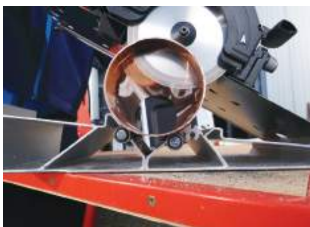
Функция зажима позволяет быстрее резать различные материалы
