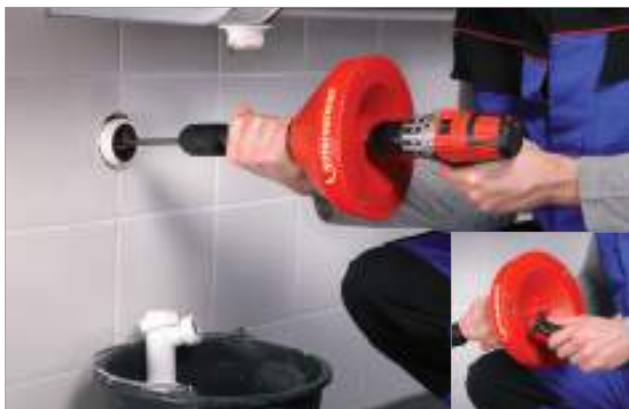
Использование шуруповёрта в качестве привода
