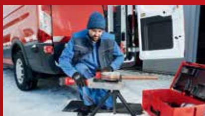
Предварительная настройка угла сгибания без использования инструмента
