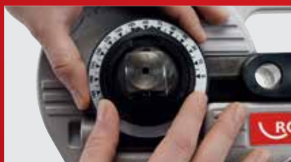
Предварительная настройка угла сгибания без использования инструмента
